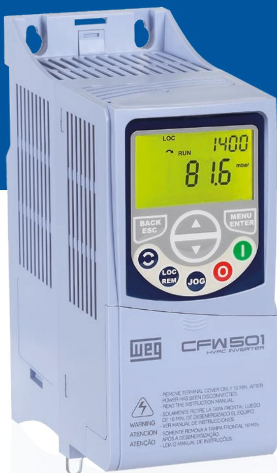
O CFW501 HVAC é um inversor de frequência da linha HVAC da WEG. Possui *Harmonic Mitigation Technology (HMT)*, que reduz a quantidade de harmônicas emitidas para a rede elétrica, podendo ser ligado diretamente a rede elétrica sem a necessidade de reatância de entrada, funções especiais que permitem economia de energia, filtro *RFI*, *SoftPLC*, que agrega ao CFW501 HVAC as funcionalidades de um CLP e *softwares* gratuitos SuperDrive G2 e WLP.
