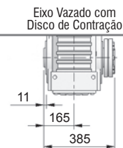
Sugestão de acoplamento no Eixo Vazado com Disco de Contração
